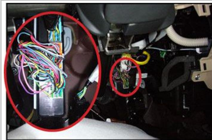
Подключение CAN шины на разъеме блока расположенного над педалью акселератора.
