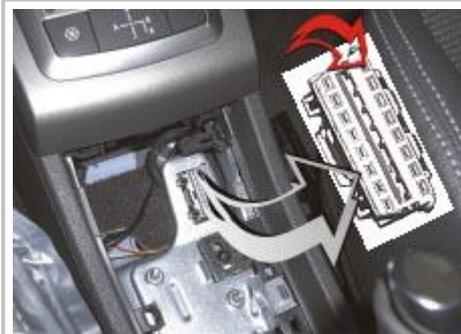
Подключение в жгуте диагностического разъёма (контакт №1)
