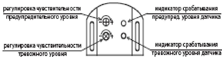
Первым настраивается предупредительный уровень. Для настройки необходимо открыть дверь автомобиля, включить режим охраны. Затем поочередно поворачивая регулировочный винт датчика по часовой стрелке и нанося легкие удары по кузову автомобиля (например на стыке рамок окон боковых дверей) добиться желаемого порога срабатывания. Далее аналогичным образом необходимо настроить тревожный уровень.
